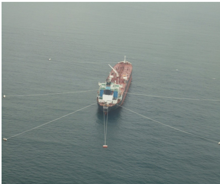
Ilustración 3. Amarradero Multiboyas Terminal Marítimo Tumaco
